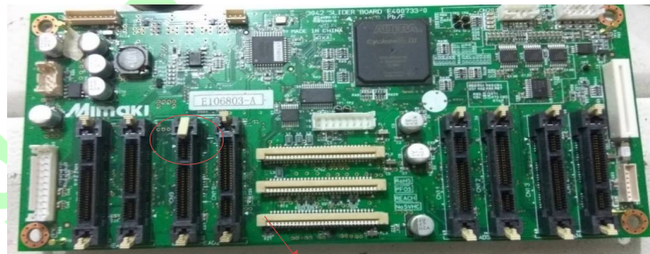
Pengunci head yang patah
